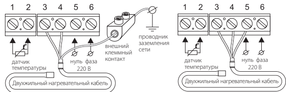
Схема подключения к 3-х проводной электрической сети
